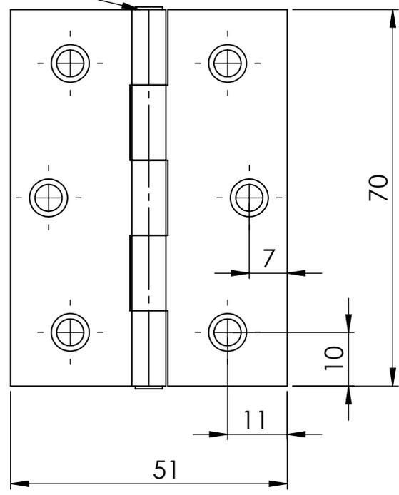
versenkt für Schraube d=3,5mm
