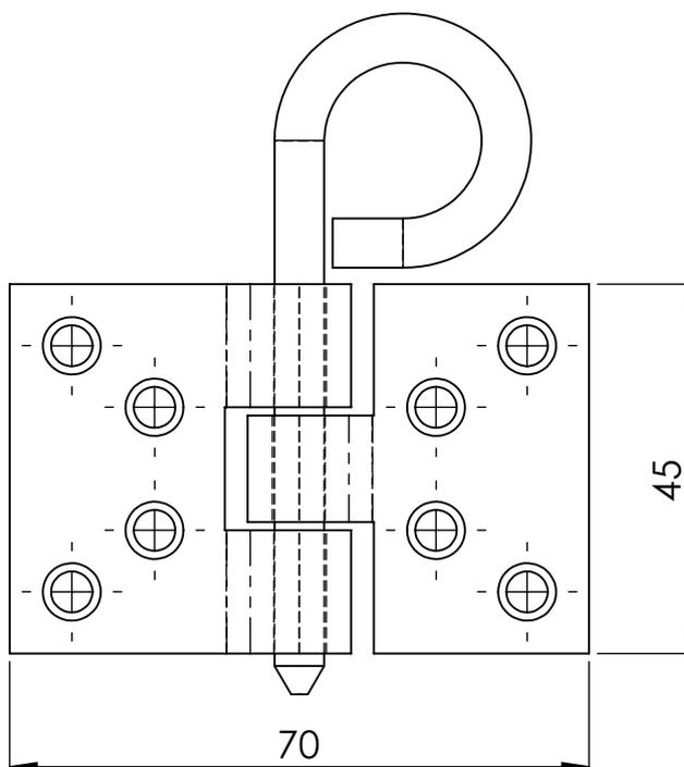
Bohrungen versenkt für 4,5mm Schrauben
