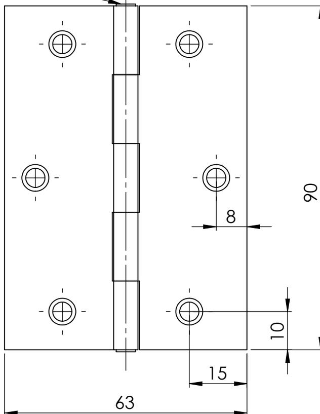
versenkt für Schraube d=3,5mm
