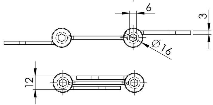
Tragkraft a 2 Scharniere: 30kg
