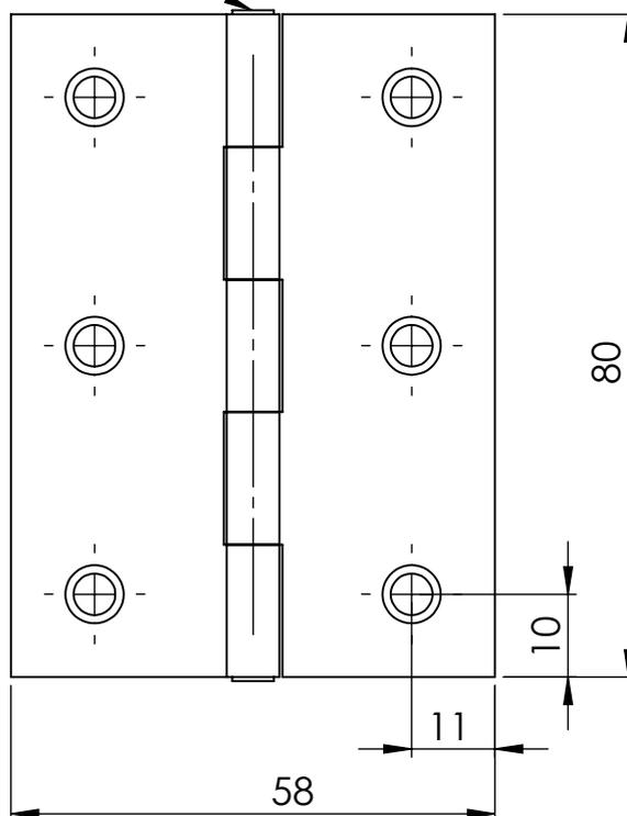
versenkt für Schraube d=3,5mm
