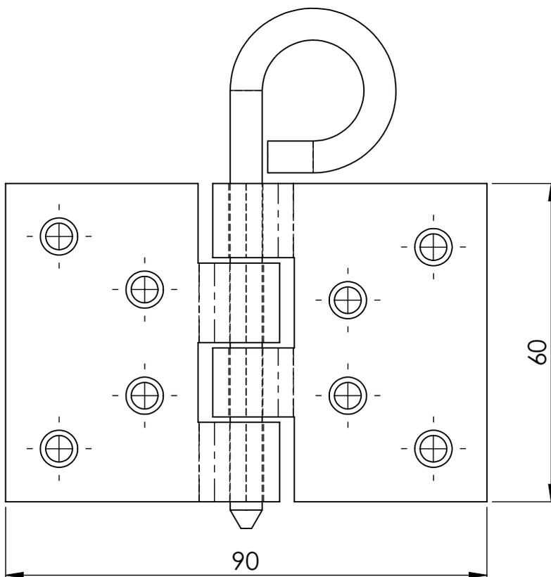
Bohrungen versenkt für 4,5mm Schrauben
