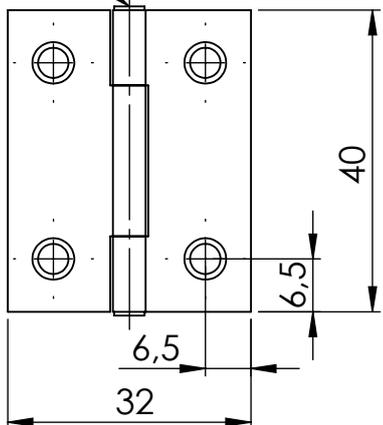
versenkt für Schraube d=2,5mm
